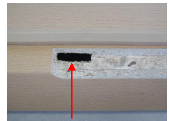
Ausreichende Größe zum einschieben der Winkel
