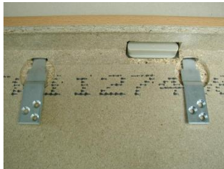
Z-Winkel parallel ausrichten und mit 5 x 20 mm Schrauben befestigen
