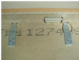
Nun können die Z- Winkel komplett angeschraubt werden
