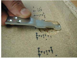
Z-Winkel von hinten einschieben
