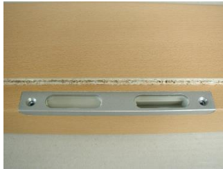
mit der Rückseite vollflächig auflegen (verhindert Abkippen der Z- Winkel)
